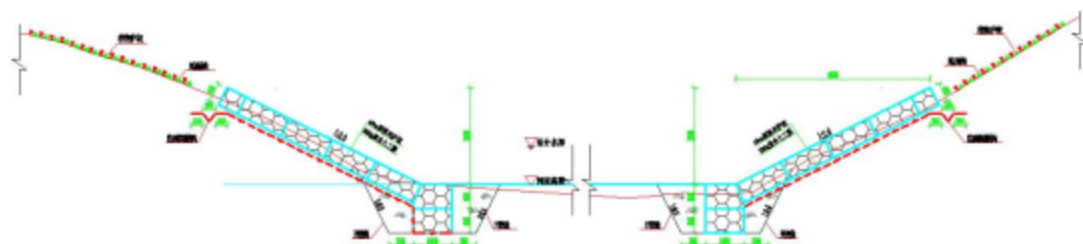
图 1 生态格宾护坡横断面结构图
