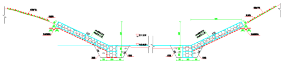
图 2-2 本项目格宾坡式护岸横断面结构图
